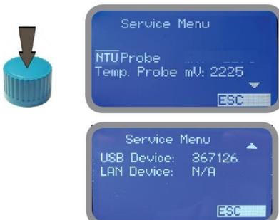
Código de conexão para o ERMES (através do cabo USB)
