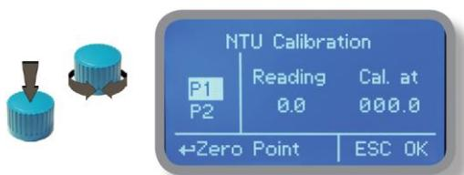
P1: valor zero. Não pode ser editado. Mergulhe a cabeça do eletrodo em uma solução 0NTU e pressione o botão uma vez que a leitura estiver estabilizada.
