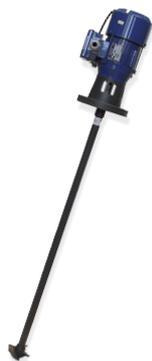
Misturador de alta velocidade, 1700 RPM. Construído em Aço Inox e revestido por PVC, com diferentes tamanhos (630 - 730 - 830 - 980 mm). Hélice diâmetro 90 mm (tipo marítima). Motor monofásico ou trifásico.
