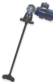
Misturador de baixa velocidade, 70 - 480 RPM. Construído em Aço Inox e revestido por PVC, com diferentes tamanhos (630 - 730 - 830 - 980 mm). Hélice de 3 pás, diâmetro 150 mm. Motor monofásico ou trifásico.
